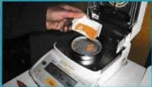
Wägung des Bohrpfeils und Feuchtmessung
